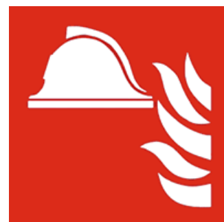
F004 Mittel und Geräte zur Brandbekämpfung
